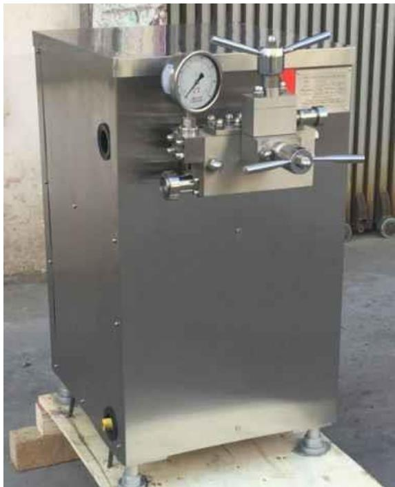
El homogenizador de alta presión se aplica a los materiales líquidos (líquido - fase líquida o fase líquida - sólida) de emulsión homogénea, la viscosidad es inferior a 0,2 Pa. Garantiza una alta estabilidad de la emulsión / solución y mejora la calidad de la conservación de los productos.
