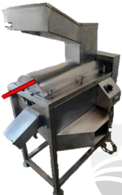
La máquina despulpadora de frutas DFA-30 es un equipo utilizado para el proceso de separación de la pulpa de las frutas de sus partes sólidas, como las semillas, la piel y otros desechos. Esta máquina es especialmente útil en la industria de alimentos y bebidas, ya que permite obtener pulpa de frutas que puede ser utilizada en la fabricación de jugos, néctares, mermeladas y otros productos.
